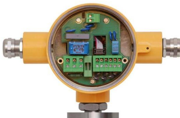
Рисунок 14 - Технологические терминалы CH1.00
