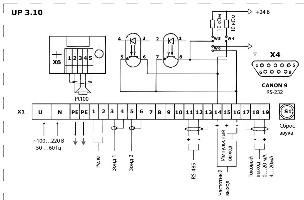
Схема электрических подключений SONOELIS SE8065
